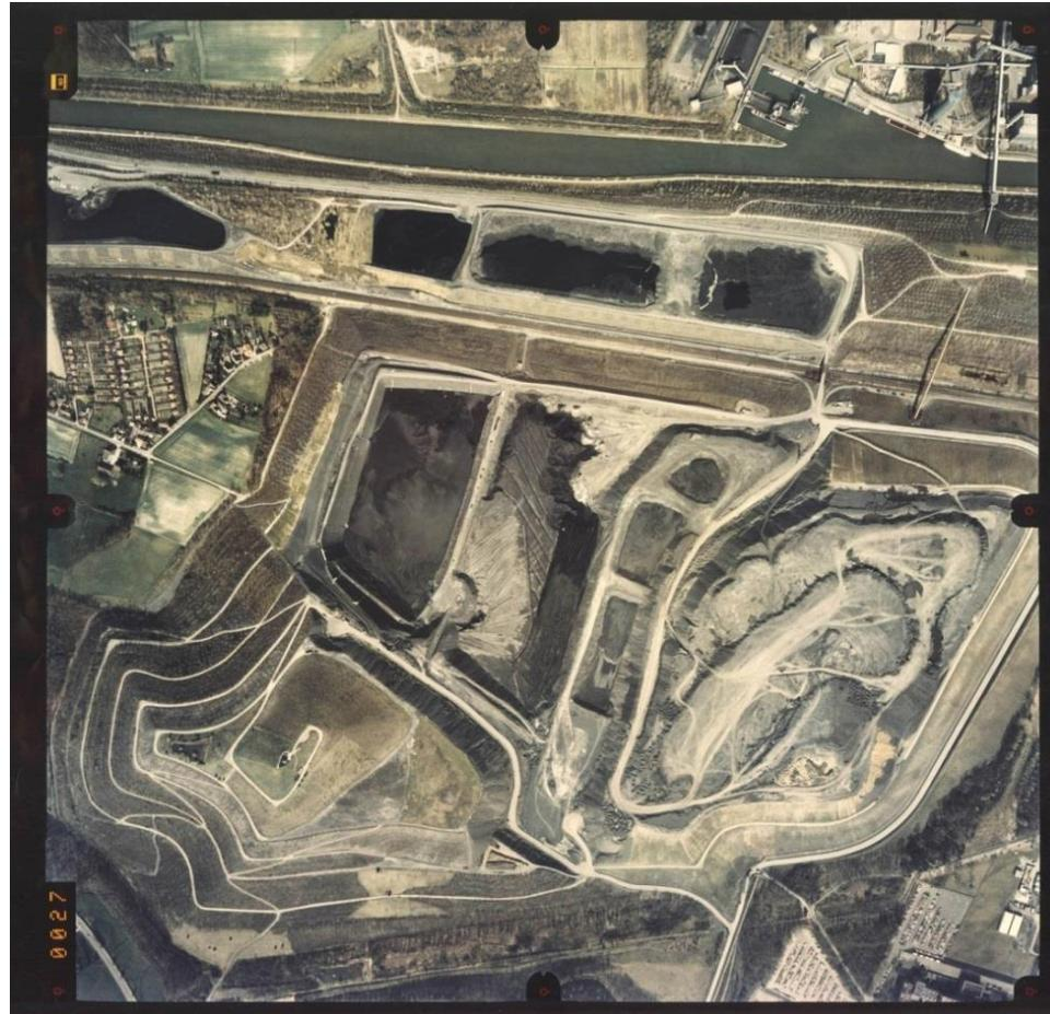
Ausgangssituation mit Böschungsflanken bis 38° und Flotationsteichen mit flüssiger bis breiiger Konsistenz
