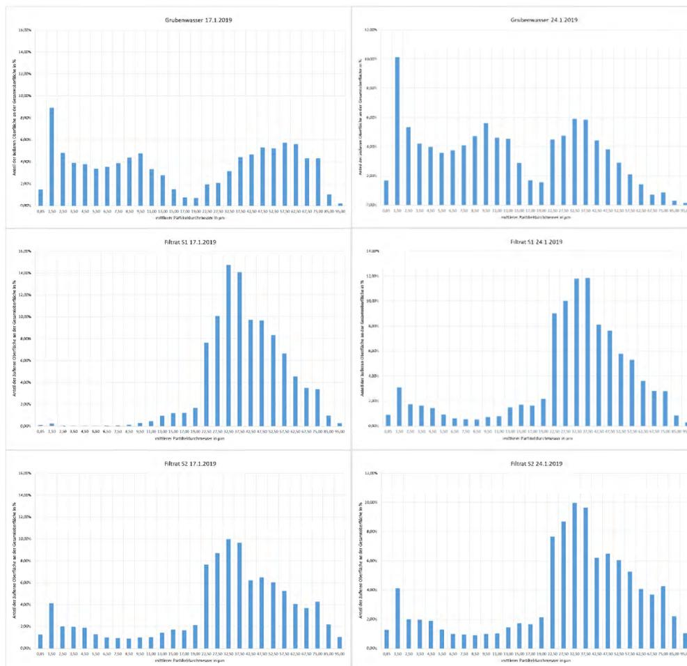
**Abbildung 13: Oberflächenverteilung bei Messungen zu Filterlauf 4**
