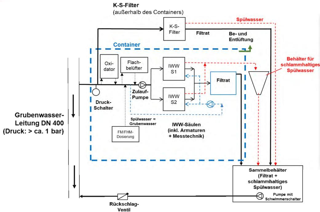
**Abbildung 3: Schematischer Anlagenaufbau am Standort Haus Aden**
