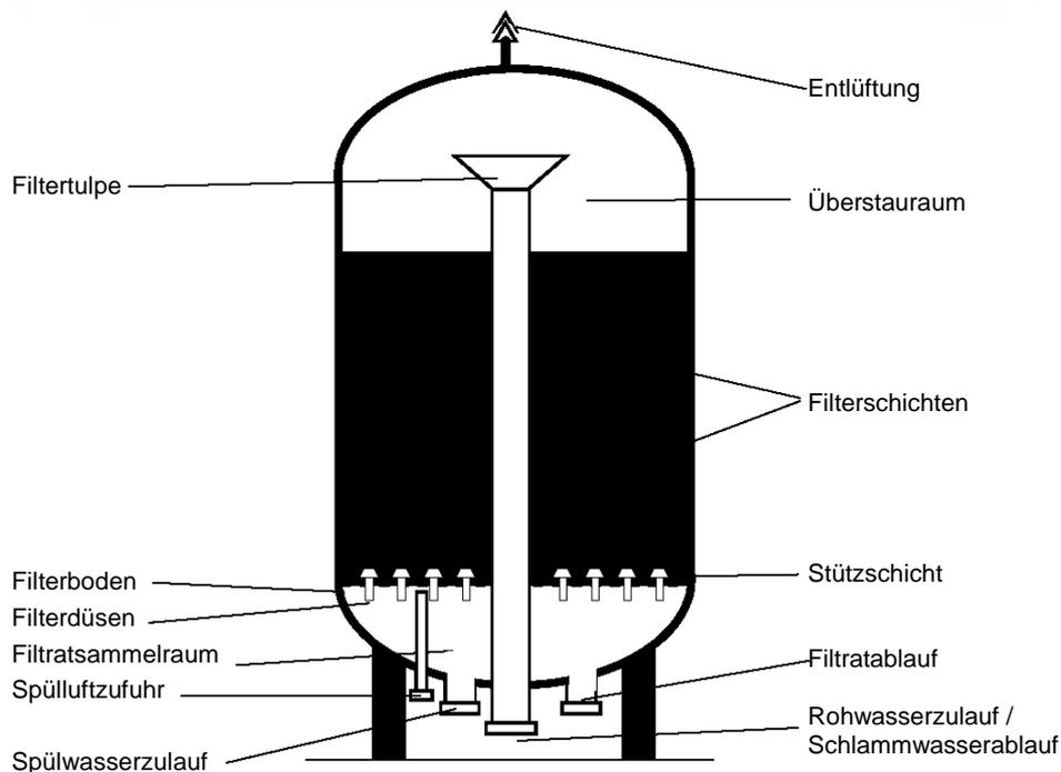
**Abbildung 1: Schematischer Aufbau eines Tiefenfilters in geschlossener Bauweise**
