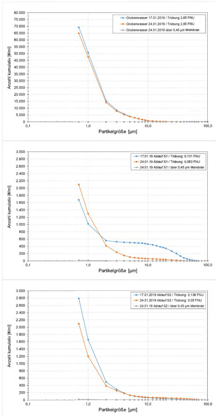
Abbildung 12: Partikelzahlen je Milliliter bei Messungen zu Filterlauf 4
