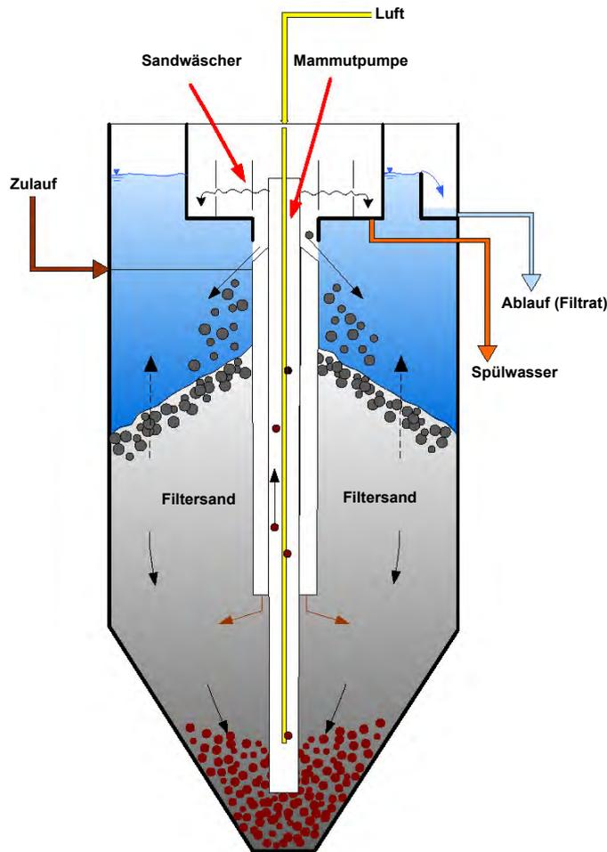
**Abbildung 2: Verfahrensprinzip eines kontinuierlich arbeitenden Sandfilters
