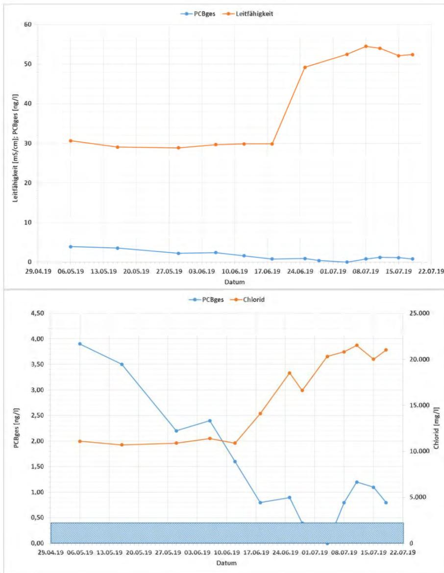
**Abbildung 21: Konzentrations- bzw. Leitfähigkeitsverlauf (Chlorid, Leitfähigkeit, PCB)**
