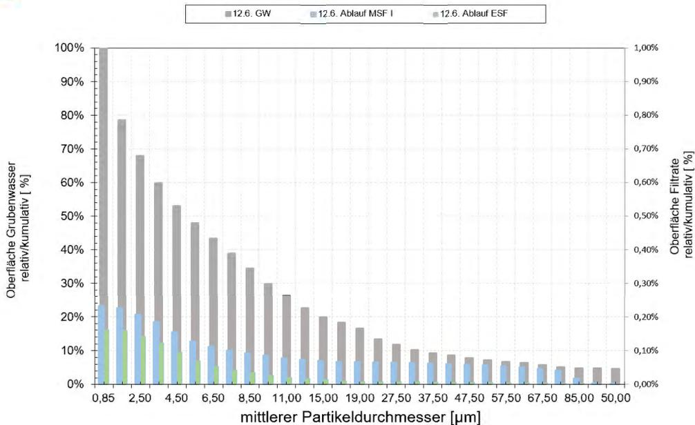
**Abbildung 20: Oberflächenverteilung der Gesamt-Partikeloberfläche in kumulativ-relativer Darstellung**
